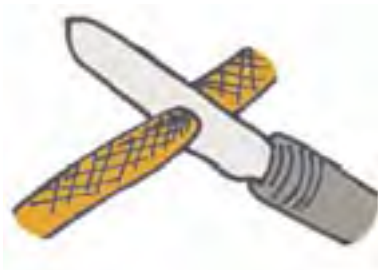
Abb. 2b: An der abgekühlten, verschmolzenen Stelle abschneiden
