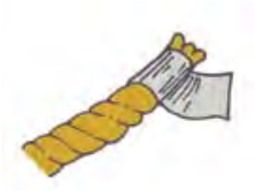
Abb. 3a: Ende mit Klebeband umwickeln
