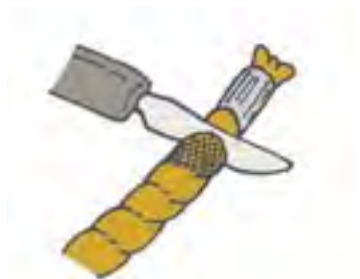
Abb. 3c: An der verschmolzenen, abgekühlten Stelle durchschneiden
