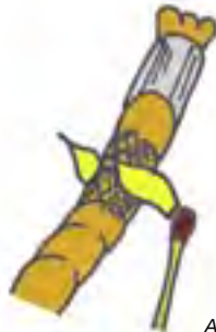
Abb. 3b: Hinter dem Klebeband erhitzen
