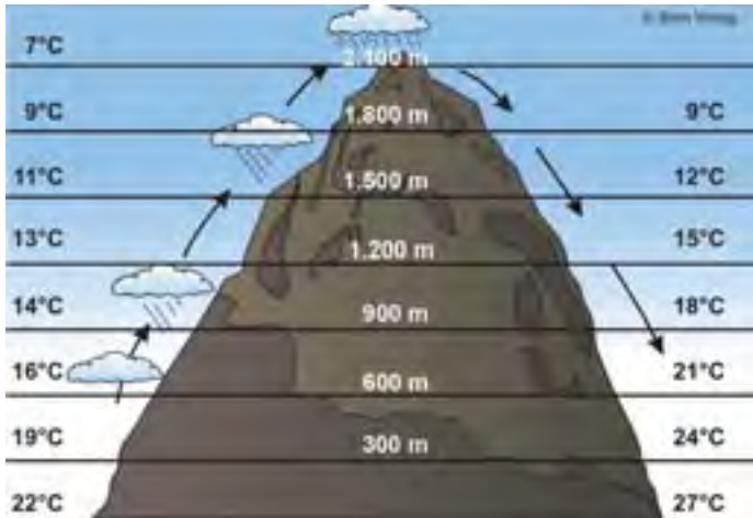
2.000-er mit adiabatischer Abkühlung und Erwärmung
